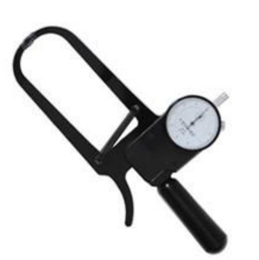
O plicômetro clínico compacto possui corpo em alumínio com revestimento pintura epóxi preta. Cabo e protetores em nylon technyl. Ponteiras fixas em nylon technyl e molas de aço zincado. Régua com marcações em milímetros. Possui abertura de 61 mm, e molas com pressão de 10 g/mm<sup>2</sup>.
