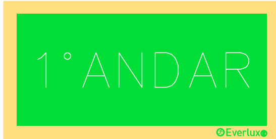
04 PLACA DE SINALIZAÇÃO INDICAÇÃO DO PAVIMENTO - CÓDIGO 19 (NBR 13434-2:2004) S/ ESCALA
