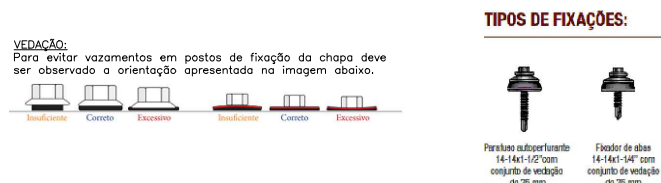
Tipos de fixações. Diagrama mostrando dois tipos de fixações para a chapa frisada em 'U'. O primeiro tipo é para o rufo de topo dentado e o segundo é para o rufo existente. Ambos os tipos são mostrados com a chapa frisada em 'U' e o rufo existente.
