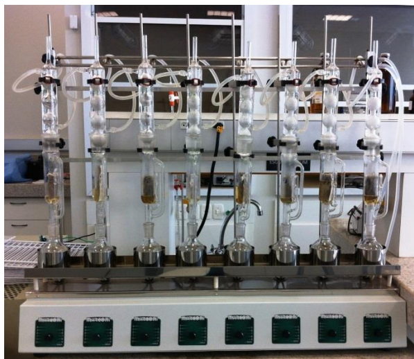
Figura 1: Estrutura do extrator de Soxhlet.
